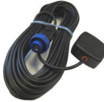
Fig. 44. Antena GPS externa.
